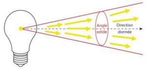
Dans une direction donnée, l'intensité lumineuse est le flux émis par l'ensemble de la source lumineuse, par unité d'un angle solide. L'unité est le lumen par stéradian, plus connue sous le nom de candela (cd).
