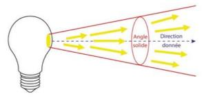
Dans une direction donnée, la luminance est l'intensité lumineuse de la source par unité de surface apparente. L'unité est le lumen par stéradian par mètre carré. De manière plus simple : candela par mètre carré (cd/m²).
