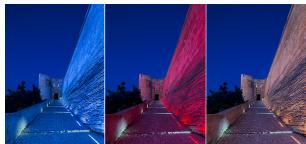
L'évolution spectaculaire de la performance des LED permet désormais d'éclairer des murs ou façades de grande hauteur, jusqu'à 50 mètres en utilisant la technique du "Wall-Washing".
