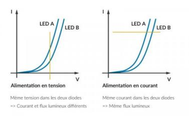
Pour que chaque diode (LED) puisse fonctionner, une **tension à ses bornes d'environ 3 Volt** est nécessaire. Si la série comprend 5 diodes, par exemple, la tension à ses bornes doit être d'environ 15 Volt. Pour fournir ce courant régulé sous une **tension suffisante**, LEC met en place un **module électronique appelé driver**.
